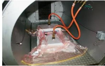
Автоклавирование – это создание изделий из композитных материалов путём запекания при высокой температуре и давлении выше атмосферного в специальном резервуаре.
