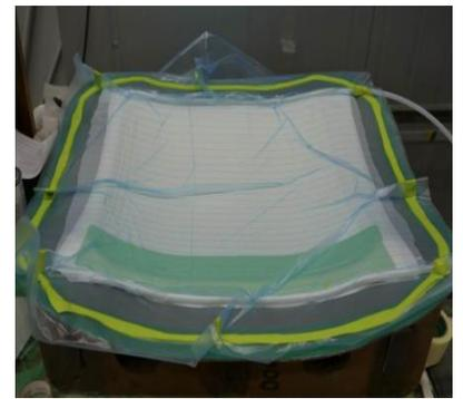
Жгут клеят по периметру оснастки для создания сцепления с двух сторон и полной герметизации в процессе вакуумной инфузии
