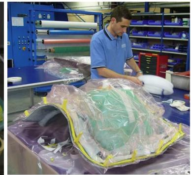
Вакуумная инфузия – этот способ создания изделий из композитных материалов, суть которого удаление воздуха из всех микроскопических пространств, чтобы его место могла занять смола, в результате чего получается монолитная деталь.
