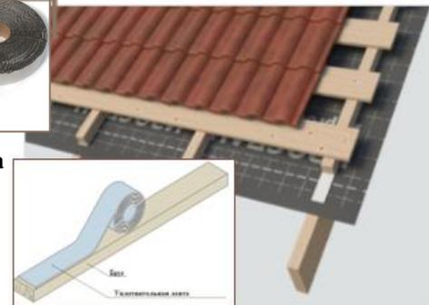
**Лента для контрбруса Липент Пи –** уплотнительная тепло- и звукоизоляционная самоклеящаяся бутиловая лента, дублирована физически или химически сшитым пенополиэтиленом
