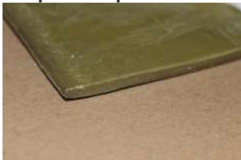
«Липлент Зи» представляет собой минеральную ленту с эффективными звукоизоляционными характеристиками. Основными параметрами данного материала, которые важны для хорошей звукоизоляции, считаются: вязкоупругость и объемный вес.
