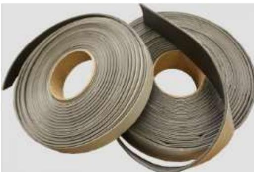
Липлент Пи представляет собой самоклеющуюся каучуковую ленту для металлического профиля с хорошими звукоизоляционными и демпфирующими характеристиками. Толщина данного материала 2мм, дублирован пенополиэтиленом (2мм), соединенного химическим либо физическим способом. Его монтируют на профили из металла, а также на верхнюю часть самой плиты (ОСП или ГКЛ) или стен. Основное применение заключается в обустройстве каркасных перегородок, требующих хорошей шумозащиты.
