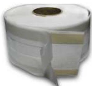
Водоизоляционная, паропроницаемая лента Липлент-Сд является материалом наружного слоя монтажного шва согласно ГОСТ 30971-2012 «Швы монтажные узлов примыканий оконных блоков к стеновым проемам», ГОСТ Р 52749-2007.
