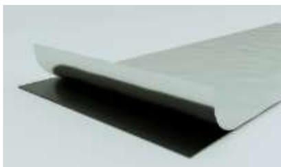
Липлент-Мф — гидро-, паро-, звукоизоляционная теплоотражающая самоклеящаяся бутилкаучуковая лента, дублирована металлической фольгой толщиной 40 мкм, имеет бутилкаучуковый слой по всей ширине ленты.
