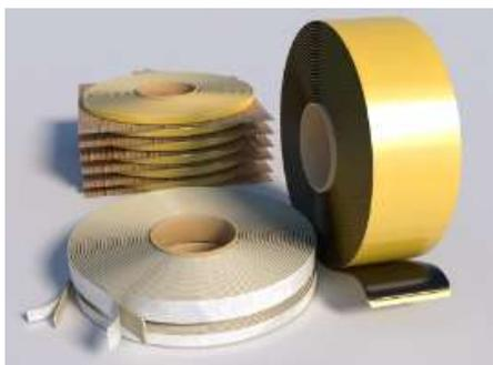
Самоклеящаяся герметизирующая бутилкаучуковая лента с двухсторонней рабочей поверхностью. Липлент-О применяется для герметизации, гидро-, звукоизоляции стыков водопропускных труб, тоннельных отделок, жестяных и шиферных кровель, герметизации светопрозрачных конструкций, стеклопакетов, для герметизации швов в полносборном домостроении, при сборке сэндвич-панелей, в машиностроении, в тепличном хозяйстве.
