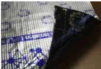
Липлент Мф Вибролент является модификацией Липлент Мф, предназначенной специально для шумоизоляции автомобиля. Представляет собой слоеные самоклеящиеся листы размерами 500x500 мм, 600x500 мм из синтетических каучуков с добавками, дублированные алюминиевой фольгой.
